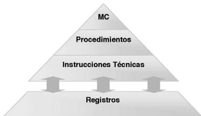
Figura 5. Representación esquemática de los niveles de documentación del sistema de gestión de la calidad
