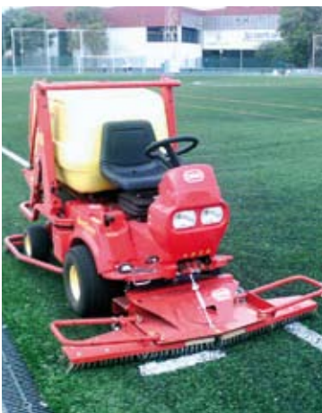
Cepillado con maquinaria especializada.
