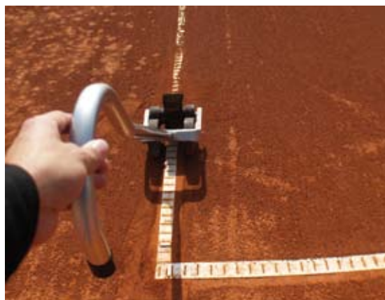
Limpieza de líneas con cepillo rotativo.
